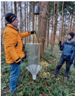
Abb. 4a BatLogger (oben) und Insektenfalle (unten), bevor sie in die Krone gehievt werden.
