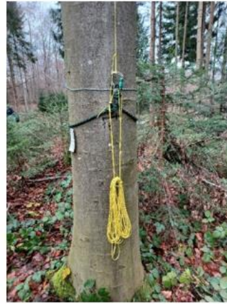
Abb. 4c. Seilbefestigungen am Stamm der Trägerbäume: Douglasie links, Buche rechts. Diese Basisinstallation am Stammfuss wird mit einer Informationsplakette mit Kontaktadresse ausgestattet
